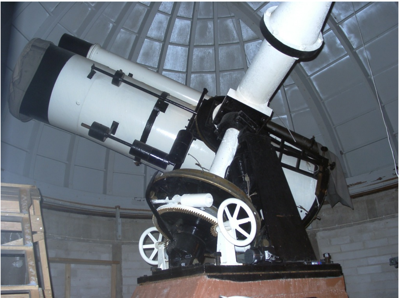
Kuva 4. Tähtitornissa sijaitseva 50 cm:n Schmidt-Väisälä-teleskooppi ja sen etsinkaukoputkena oleva 18 cm:n linssikaukoputki.
