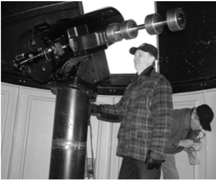
Kaukoputki lyhennetyllä pilarilla
