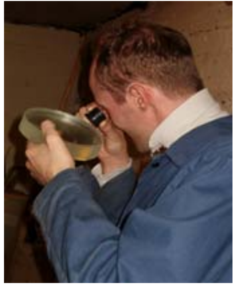
Tapio Pokela tarkastelee peilin pinnan sileyttä lupilla.
