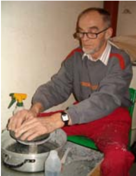
Aatos Hongisto hiomassa kaukoputken objektiivipeiliä ”puoliautomaattisella” hiontakoneella.
