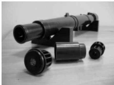
Edessä 20 mm okulaari, barlow-linssi ja lisä-okulaari. Takana itse putki ja tarkennusputki
