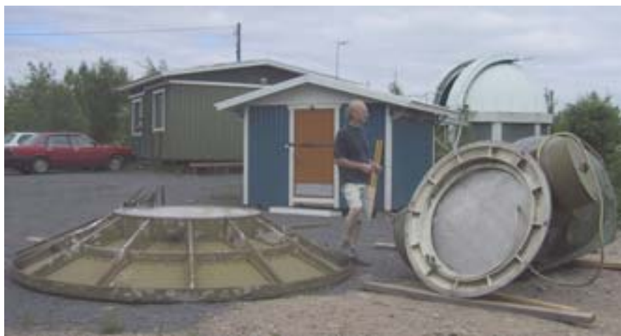
Radioteleskoopin ensimmäinen ja painavin osa saapui Nyrölään 30.6.2003. Noin puolitoista tonnia painava jalusta kääntökoneistoinen tuotiin pienellä kuorma-autolla Pietarista. Teleskoopin kolmimetrinen peili saapui samalla autolla viikkoa myöhemmin.
