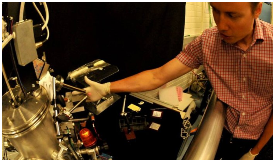
Mikko Laitinen näyttää mihin mitattava näyte asetetaan. Lasersäteiden leikkauspiste osoittaa neutronisuihkun paikan.
