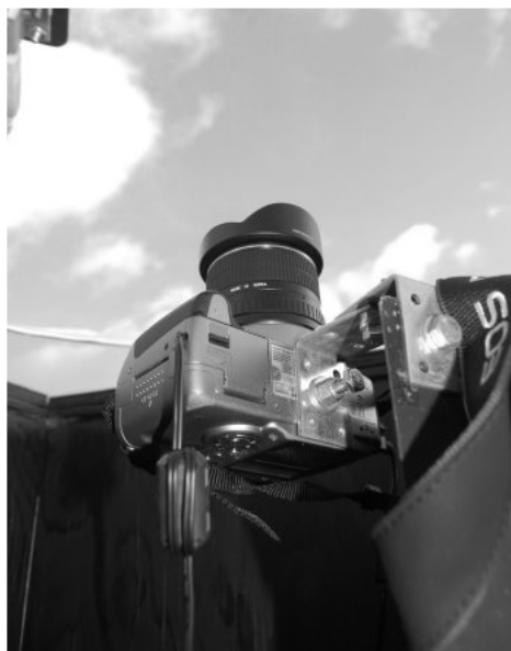
Canon EOS 350D kamera ja Samyang 8 mm kalansilmäobjektiivi revontulikuvussa.
