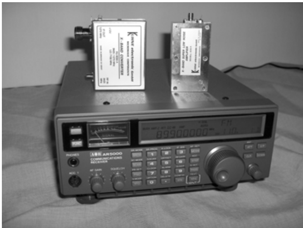
AR5000 vastaanottimen päällä 8.4 GHz:n konverteri ja etuvahvistin
