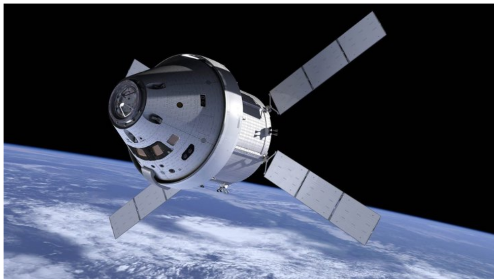
Orion miehistökapseli ja ATV-perustainen huoltokapseli, kuva NASA.
