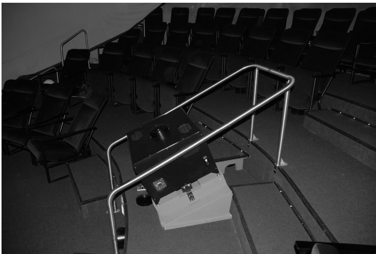
Uusin digitaali tekniikka tekee laitteista pienikokoisia. Tällä projektorilla ja sen kalansilmäobjektiivilla hoidellaan esitys neljän tietokoneen yhteistyönä.
