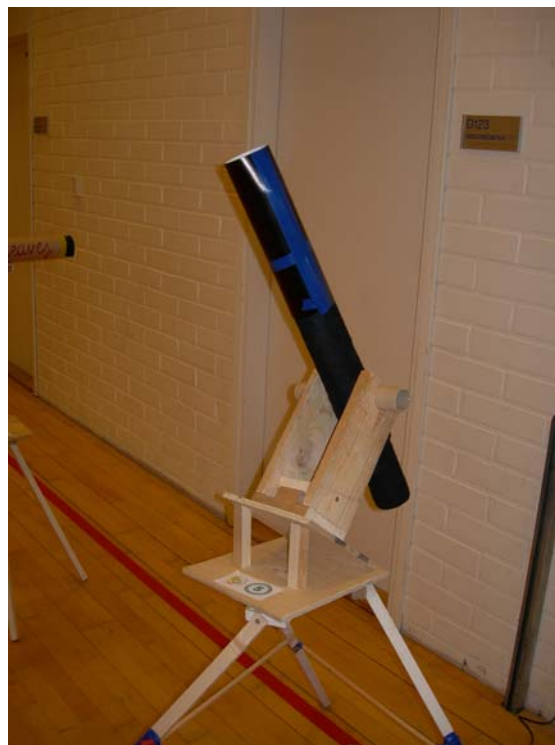
Tiimissä, jossa oli kaksi tähtitieteenharrastajaa, oli itsestäänselvyys päätyä rakentamaan ekvatoriaalinen jalusta. Kuva Merike Kesler.
