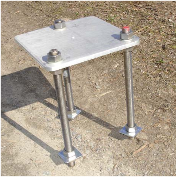
Pylvään valuun upotettiin kierretangot, johon kiinnityslevy kiinnitetään.
