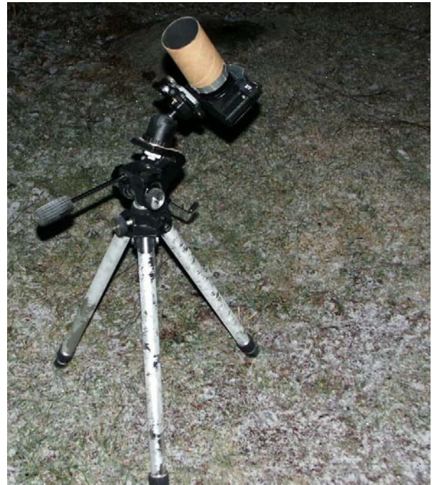
Laitteisto valmiina viivakuvauksia varten. Kameran objektiivin edessä oleva "tötterö" on itse askarreltu vastavalosuoja.
