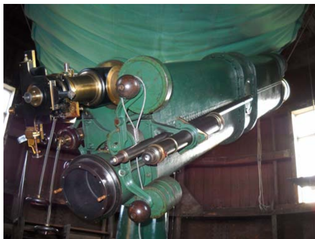
Observatorion Uuden tähtitornin kaksoisrefraktori, jossa on alla 330 mm valokuvausputki ja yllä 254 mm visuaaliputki. Putki on täydessä käyttökunnossa. Kuva Seppo Linna-luoto.
