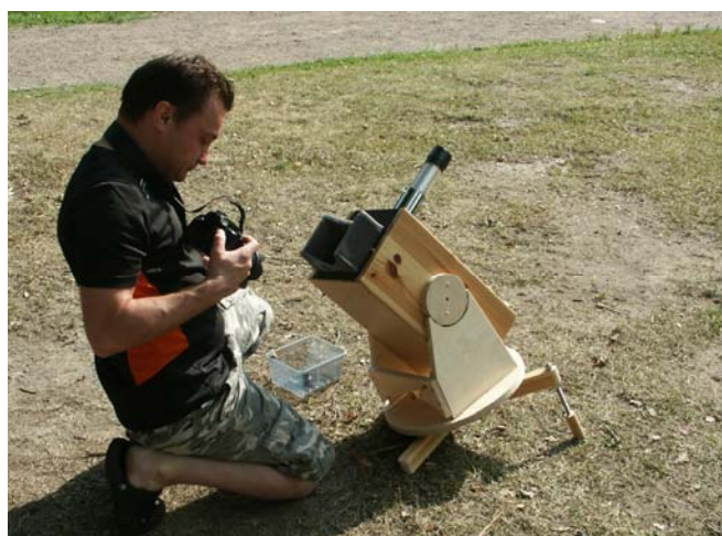
Mielenkiintoinen auringonhavaintolaite. Auringon kuva heijastetaan laatikon pohjalla olevalle pallopinnalle. Kuva Heikki Marttila.
