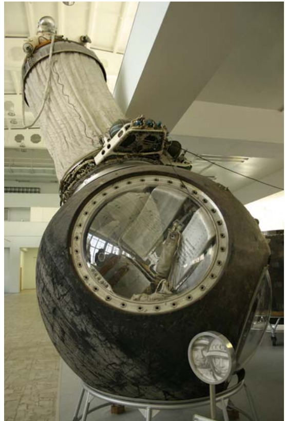
Vostok 2 avaruusaluksen aito laskeutumismoduuli. Puhallettava ilmalukko on maanpäällinen malli. Kuva: Antti Kuosmanen.
