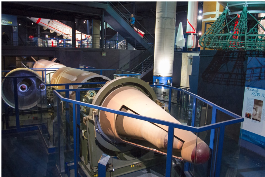
SSBS S3, ranskalainen pitkän kantaman ohjus. Kaksivaiheinen, voitiin varustaa ydinkärjellä. Oli käyttövalmiudessa vuosina 1980-1996.
