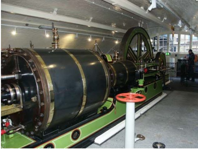
Tässä matkan toinen höyrykone. Tämä oli joskus osa nostosillan käyttökoneistoa.
