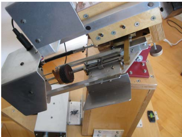
Kuva 2. Yksityiskohtainen kuva ruuvista ja siihen liittyvästä luistista ”konepelti” avattuna.
