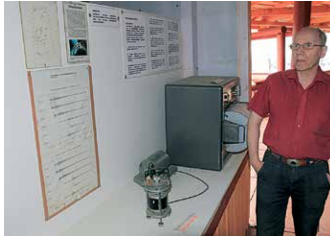
Kuva 7b. Alajärven Tulivuorikeskuksessa on nähtävillä maanjäristyksen voimakkuutta rekisteröivä laite. Seismometri vastaanottaa järistysaalloit, jotka kulkeutuvat seismografiin, joka merkitsee ne paperirullalle (nk. seismogrammi). Kuvassa Risto Saarela kertoo miten laite toimii. Kuva: Satu Hietala, GTK.
