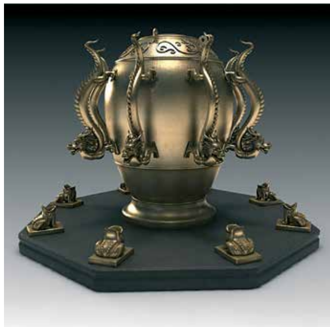
Kuva 7a. Kiinalainen Zhang Hengin vuonna 132 kehittämä seismometri oli maailman ensimmäinen maanjäristyksiä ennakoiva laite. Instrumentin ylälaidalla on kahdeksan lohikäärmeen päätä, ja jokaisella lohikäärmeellä on suussaan metallinen pallo. Vastaavasti jokaisen lohikäärmeen pään alapuolella istuu metallinen sammakko, joka kurkottaa yläviistoon suu auki. Laitteen sisällä on pystysuora painava keskusakseli. Pystysuora vakain reagoi maan tärtähtelyyn ja sen seurauksena vakain siirtyy paikaltaan. Tämä liike välittyy lohikäärmeen kitaan ja kidassa oleva metallipallo putoaa alapuolella ammittavaan sammakon suuhun. Päättellen siitä, minkä sammakon suuhun pallo kulloinkin kilahtaa, voidaan tietää missä ilmansuunnassa maanjäristys on tapahtunut. ( http://fi.gbtimes.com/elama/zheng-heng-ja-seismografiset-sammakot ). Kuva: http://pixshark.com/chinese-seismograph.htm
