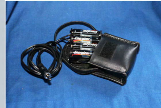
Paristokotelo on hyödyllinen, mutta kaapeliliitännät toimivat vain juuri ja juuri. Kierrekiinnitys laitteen runkoon onkin aivan välttämätön höllän rakenteen ansiosta.
