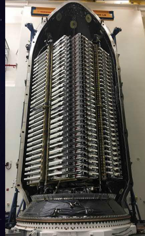
Falcon 9 –kantoraketin Starlink-lasti (Kuva: SpaceX)
