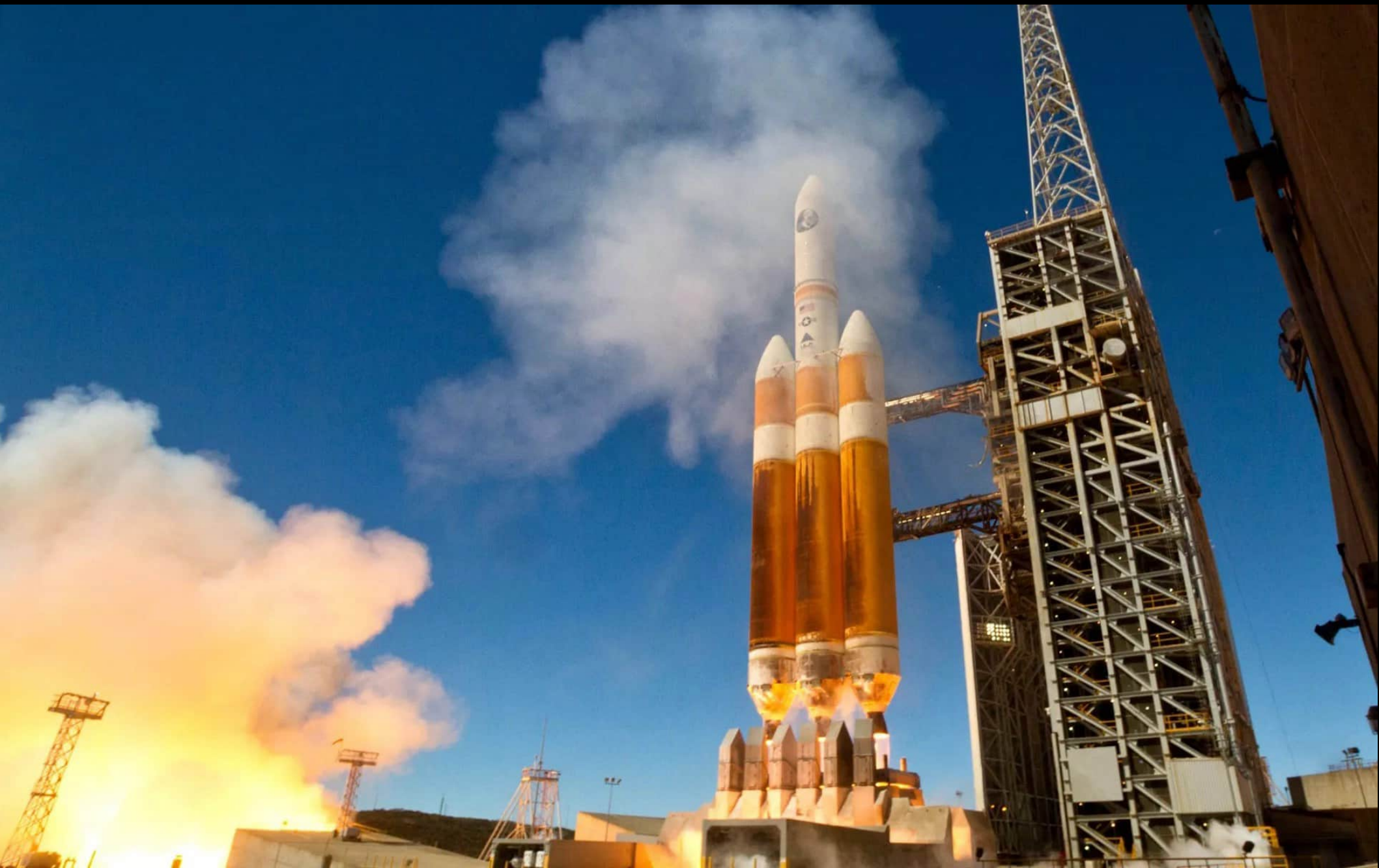
Delta IV Heavy: tehokkain LH2 / LOX -moottori, työntövoima 3 140 kN
