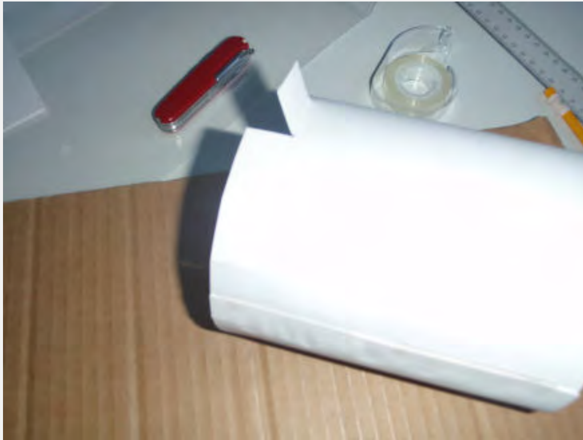
Kuva 5. Siivekkeiden leikkaaminen pahviputken toiseen päähän.
