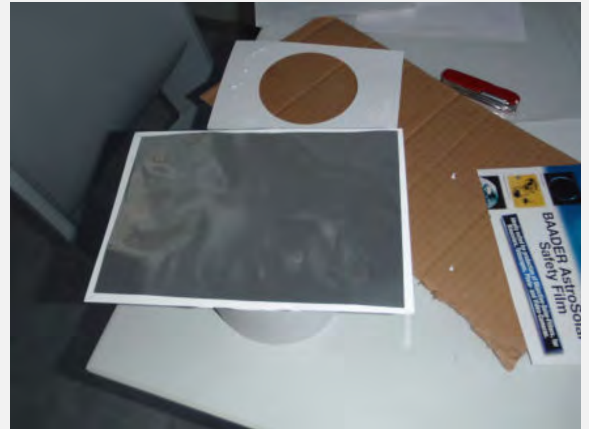
Kuva 7. Suodinkalvon asettaminen kahden reiällisen kartonginpalan väliin.
