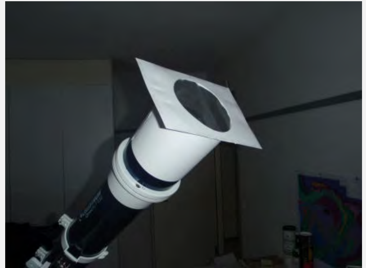
Kuva 9. Aurinkosuodin kaukoputken objektiivipäässä. Nyt auringon katselu kaukoputkella on turvallista!
