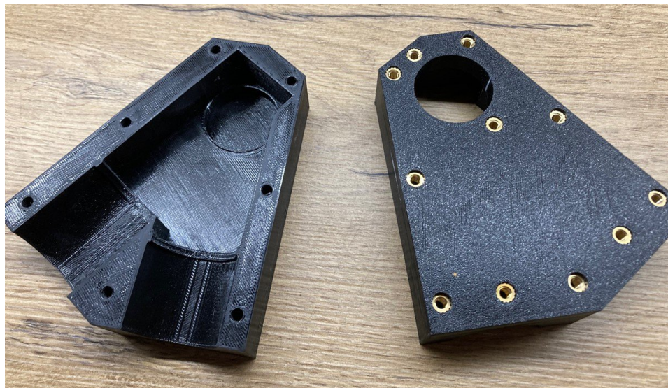
Kuva 1. 3D-tulostetut runkoelementit ja toiseen puolikkaaseen asennetut ruuvi-insertit.
