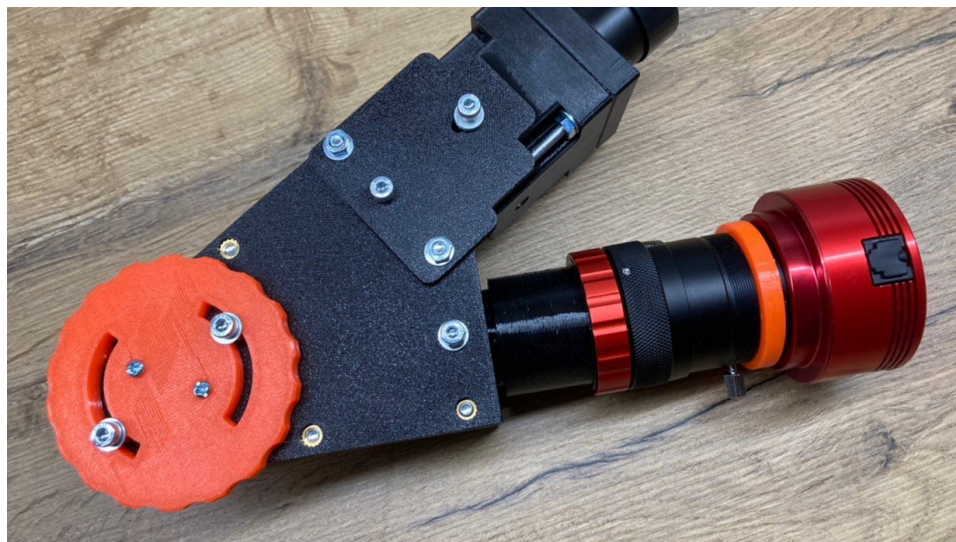
Kuva 2. Havaintovalmis spektroheliografi Sol'Ex. Aallonpituus valitaan oranssin väristä hilapidintä pyörittämällä.
