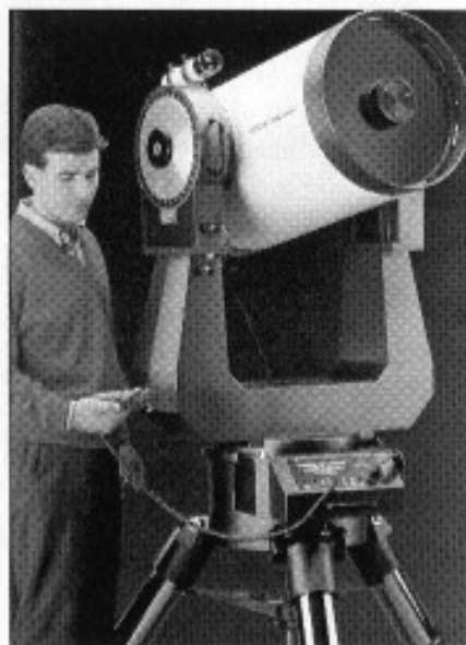
Kaukoputken alumiininen jalustahaarukka ja ohjainnäppäimistö.
