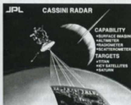
Cassinin tutkan toimintaperiaate. Kuva NASA.
